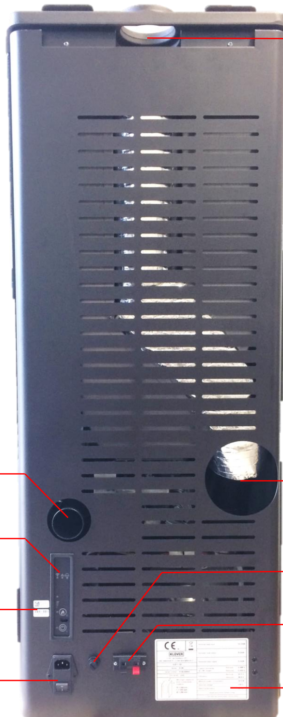
Entstörfilter: Hauptschalter, Anschluss für Versorgungskabel und 2 eingebaute Sicherungen (4A 250V).
